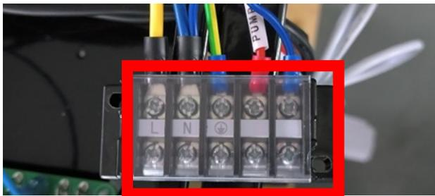
Überprüfen Sie, ob die Spannung normal ist, wenn das Gerät in Betrieb ist.
