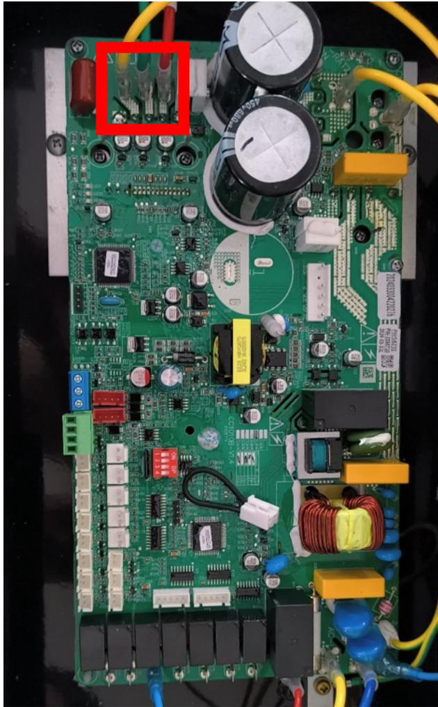
1. Prüfen Sie, ob das Wechselrichtermodul überhitzt ist
